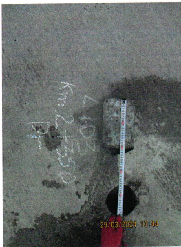
Figura 16. Măsurarea grosimilor și împachetarea probelor.
