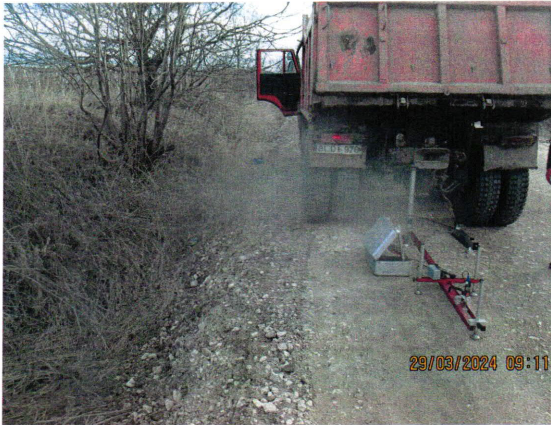
Figura 10. Măsurarea capacității portante la nivelul stratului de fundare (L103 km 0+200).
