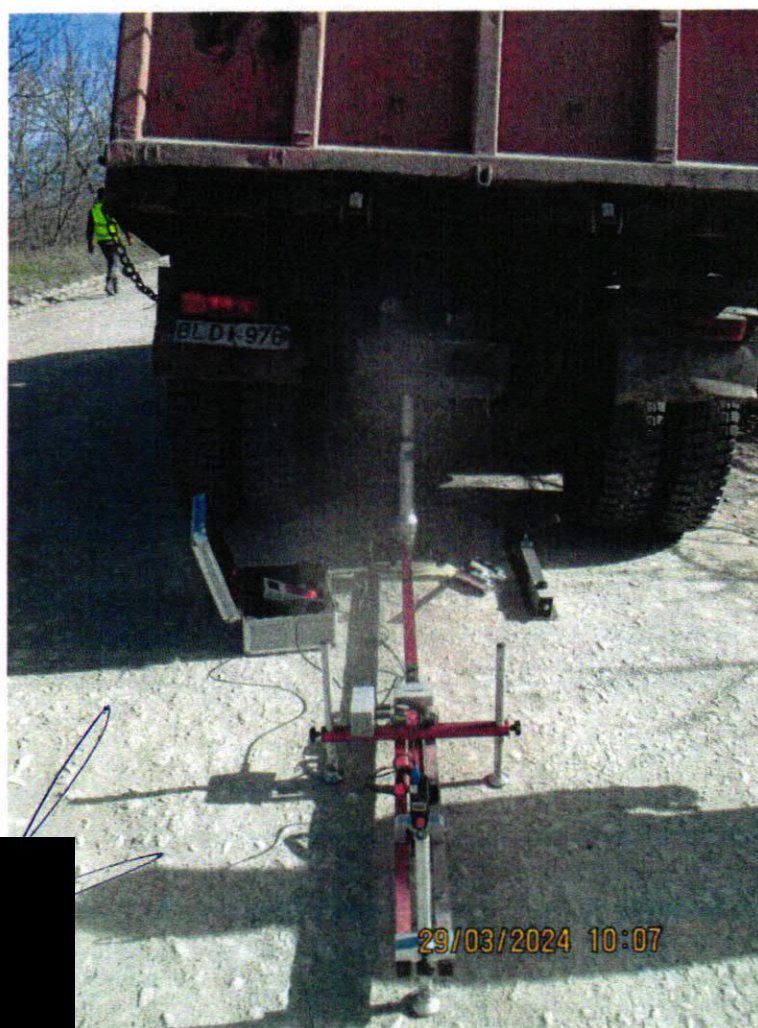
Figura 13. Poziția de lucru a plăcii Lukas (L103 km 0+600)
