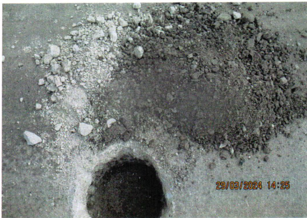
Figura 12. Pregătirea suprafeței pentru testul cu placa Lukas (L103 km 3+150).
